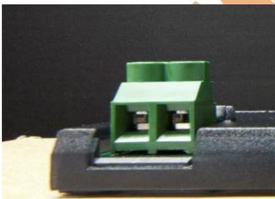
3 端子台が下まで行ったことを確認した後、ケーブルを端子台にはさみ端子台のねじを時計回りで締めてください。
