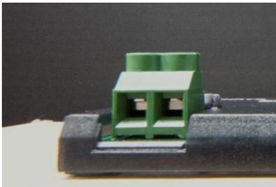
1. SolarAmp B 出荷状態はねじが締まった状態で端子台は上に上がっています。
